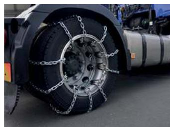
Je nach Einsatzbedingung können bis zu 10 Stränge montiert werden!
